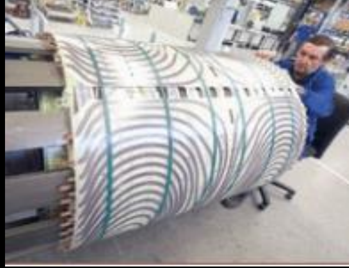
Bobina de gradiente com enrolamentos distribuídos gravados em folhas condutoras de cobre (cortesia GEMS)
